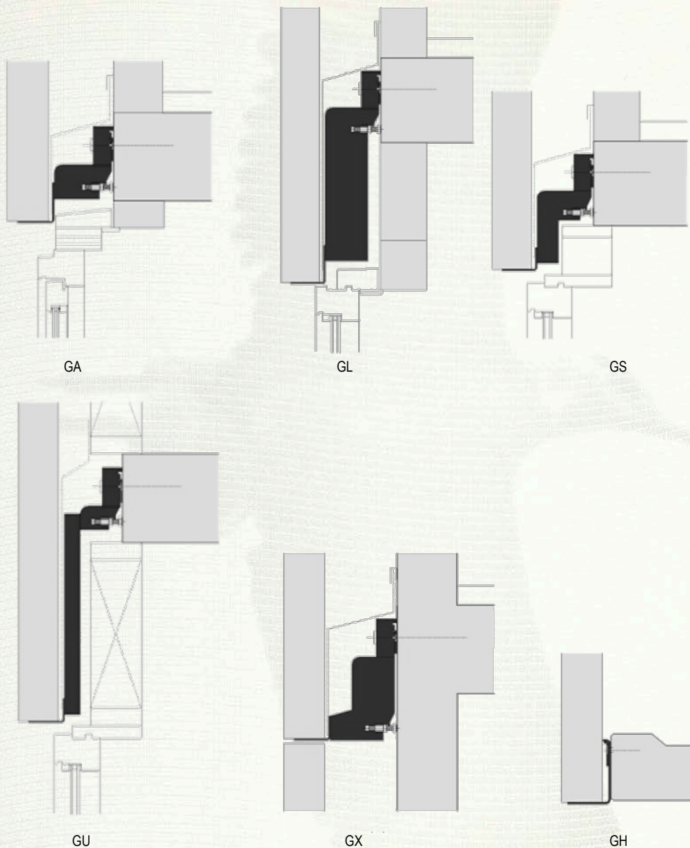
Figuur 9: Metselwerkondersteuning met codering GA, GL, GS, GU, GX, GH
